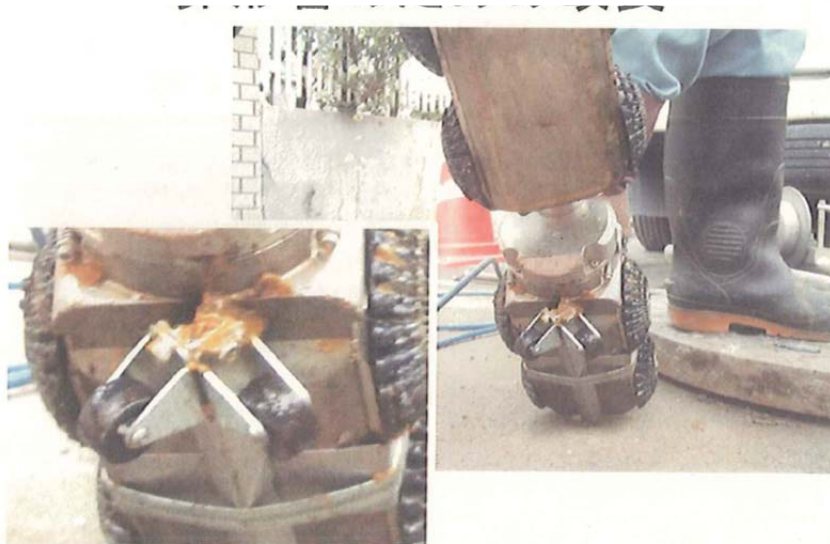
図 6.6.3. (7) テレビカメラ調査の工夫事例
